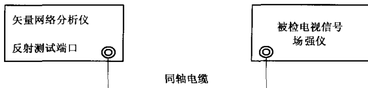
图 5 矢量网络分析仪检定输入端口电压驻波比
